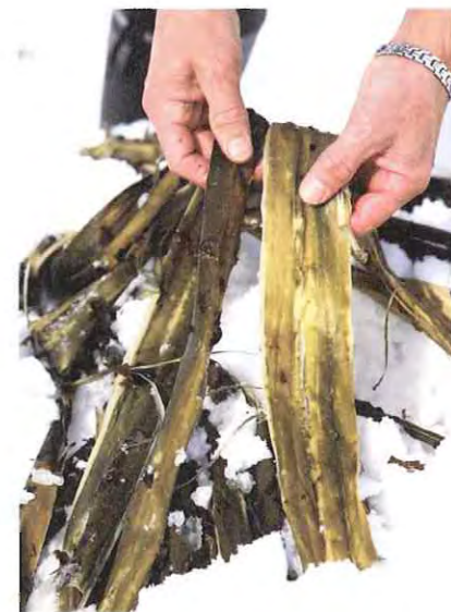
雪晒し途中の楮の樹皮。白っぽくなっているところが漂白された部分。1週間ほど晒してさらに白くする。
